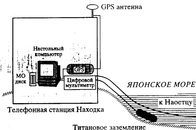
Рис. 1. Схема расположения кабеля JASC, электродов заземления и измерительной установки, расположенной на кабельной станции Находка.
